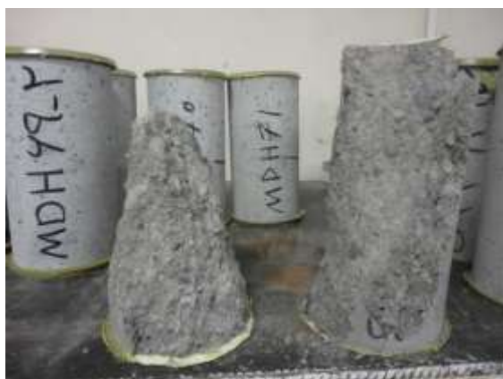
شکل ۲- (اجرای عملیات تعیین مقاومت فشاری نمونه ها)
