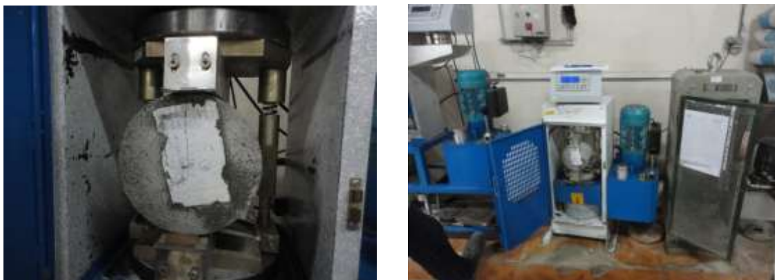
شکل ۳- (تعیین مقاومت کششی به روش برزلی)
