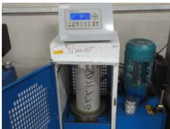
شکل ۲- (اجرای عملیات تعیین مقاومت فشاری نمونه ها)
