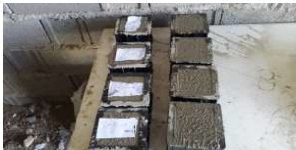
شکل ۴ نمونه گیری کنترل و نانو از بتن تازه
