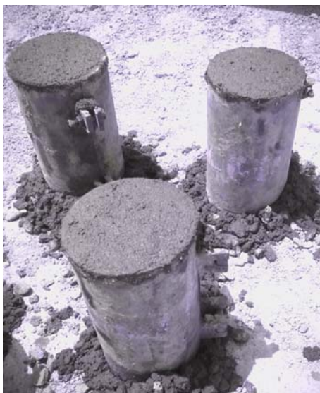
شکل ۳- نمونه های بتنی تهیه شده در کارگاه
