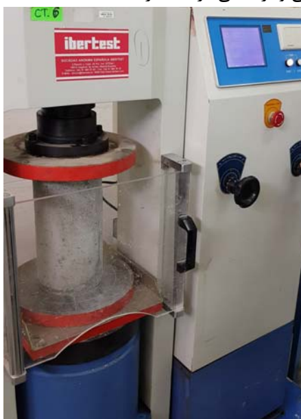
شکل ۵- شکستن نمونه های آزمایشی جک شرکت IBERTEST
