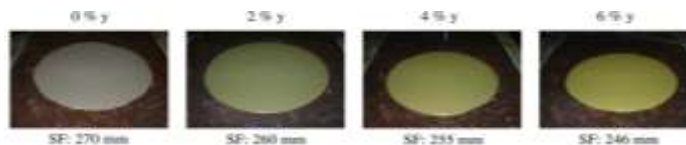
شکل (۲) اثر افزایش میزان رنگدانه زرد هیدروکسید آهن بر روانی [۷]
