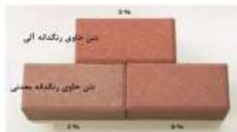
شکل (۱) مقایسه شدت رنگ دو رنگدانه با اندازه متفاوت [۶]
