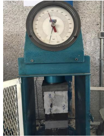
تصویر ۲-الف- سنجش مقاومت فشاری بتن
