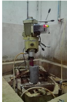
شکل ۱- مغزه گیری از آزمون ی استوانه ای
