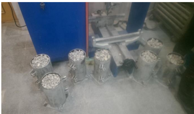
شکل ۳- قرار دادن ذرات شن درون قالب‌ها جهت ساخت بتن پیش‌آکنده
