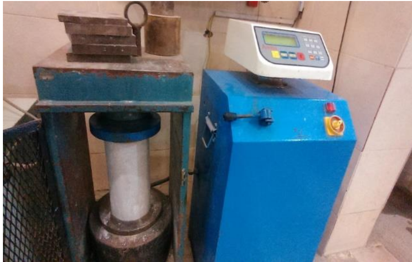
شکل ۵-آزمایش مقاومت فشاری تک محوره بر روی آزمون‌های استاندارد
