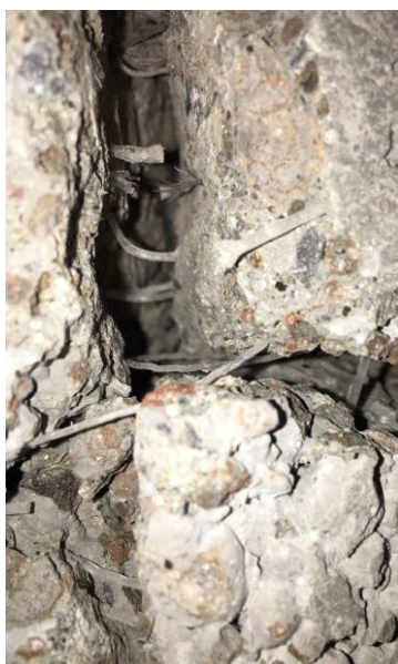
شکل ۳- تصویر پل زدن الیاف پلی اتیلن و شکست نمونه استوانه‌ای
