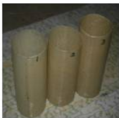
شکل ۲: مقطع ستون cfft
