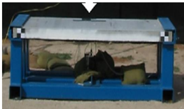
شکل ۱- آزمایش بار انفجار بر روی دال بتنی [7].
