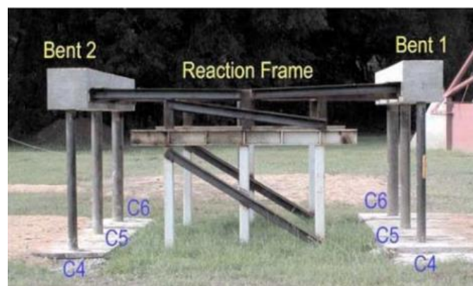
شکل ۷- بررسی آزمایشگاهی اثر بار انفجار بر پایه پل‌ها [8].
