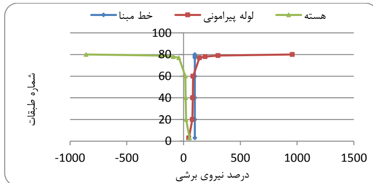
شکل ۱۲: درصد مشارکت لوله پیرامونی و هسته در تحمل نیروی جانبی در سیستم لوله - هسته
