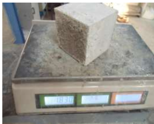
شکل ۹ - توزین نمونه ۱۰*۱۰*۱۰ طرح scc108
