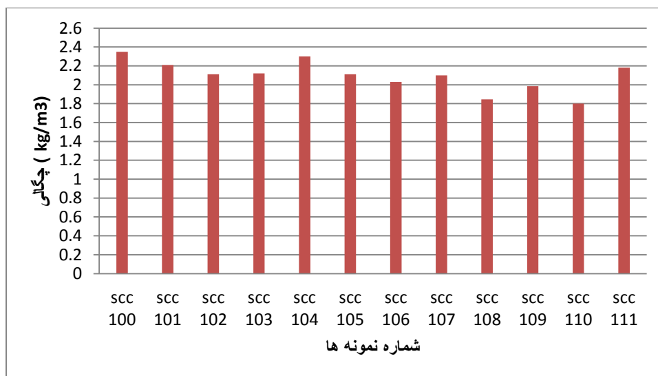
شکل ۸ - نمودار میله ای مقایسه چگالی نمونه ها
