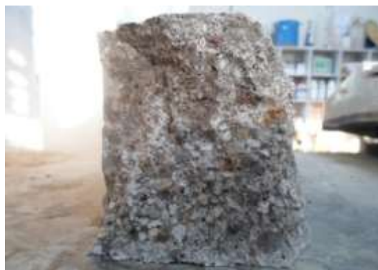
شکل ۱۱ - آزمون ۲۸ روزه مربوطه به طرح scc108 پس بارگذاری فشاری
