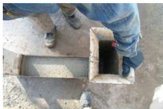
شکل ۵- آزمایش جعبه L
