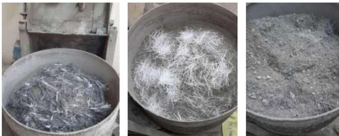
شکل ۳: اضافه کردن الیاف به مصالح خشک
