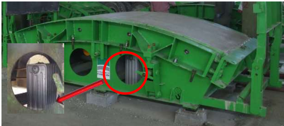
شکل ۶- سیستم انتقال حرارت در زیر قالب های سگمنت
