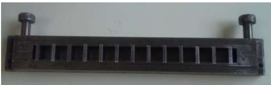
شکل (۳- الف) قالب های مورد استفاده در ساخت نمونه های بتنی حاوی نانو هماتیت
