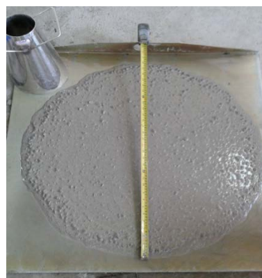
شکل (۴): آزمایش جریان اسلامپ
