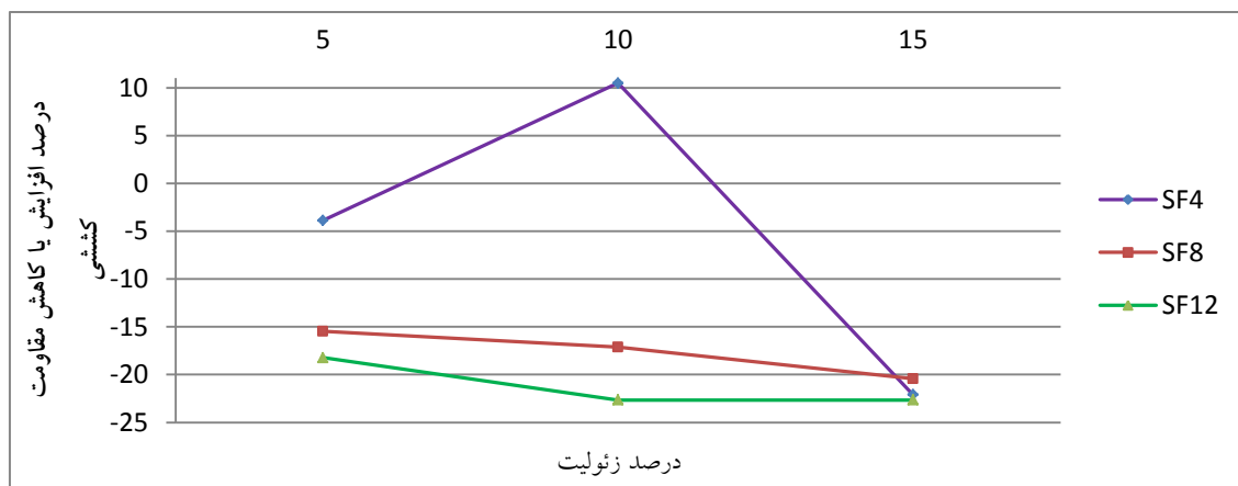
شکل ۲- درصد افزایش یا کاهش مقاومت کششی نمونه‌های ترکیبی ژئولیت و میکروسیلیس در سن ۲۸ روز
