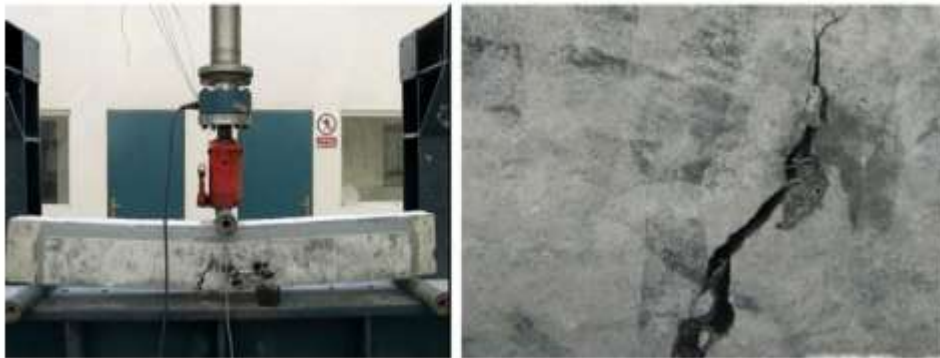
شکل ۵ نحوه ترک خوردگی تیر مقاوم‌سازی شده از نوع S-re
