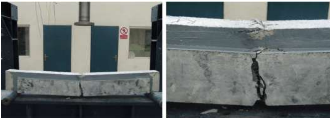
شکل ۸ نحوه ترک خوردگی تیر مقاوم‌سازی شده از نوع B-re
