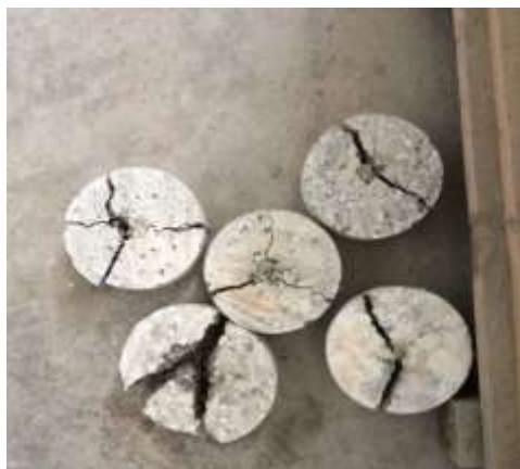
شکل ۶. نمونه های دیسک بعد از آزمایشات ضربه
