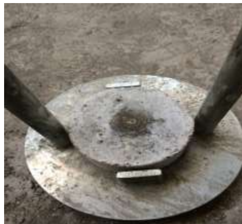
شکل ۶. نمونه های دیسک بعد از آزمایشات ضربه
