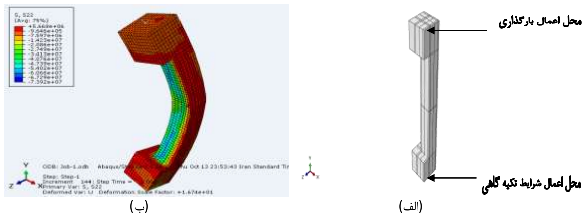
شکل ۵- الف ( نحوه بارگذاری ب ) تغییر شکل ستون تحلیل شده
