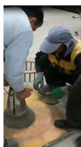
شکل ۱۲: آزمایش اسلامپ و جریان اسلامپ T=50 سانتیمتر
