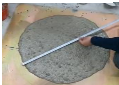
شکل ۱۲: آزمایش اسلامپ و جریان اسلامپ T=50 سانتیمتر
