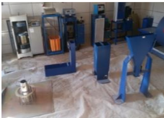
شکل ۸: کلیه تجهیزات انجام آزمایشات بتن تازه خودمتراکم
