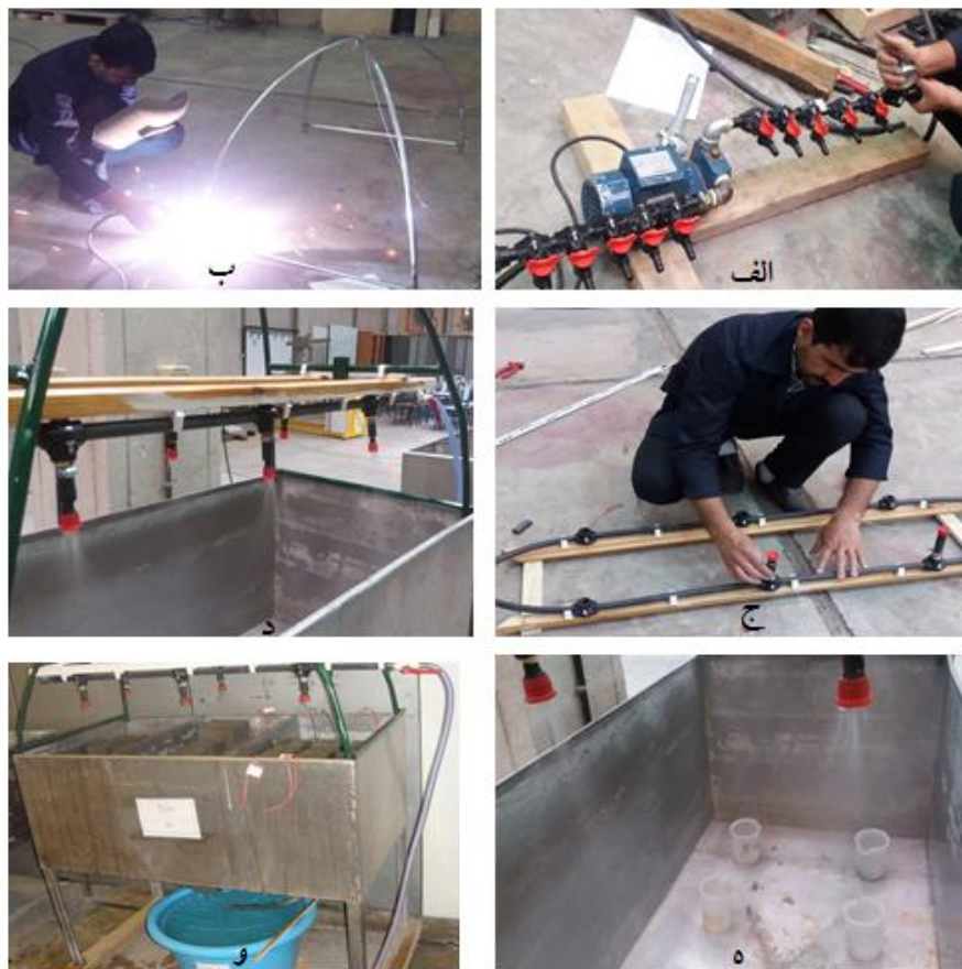
شکل (۳) مراحل ساخت دستگاه شبیه‌ساز باران اسیدی (الف) به هم بستن پمپ و شیرها (ب) ساخت فریم دستگاه (ج) بستن نازل‌ها و شلنگ‌ها به فریم (د) سوار کردن فریم بر مخزن نمونه‌ها (ه) کالیبره کردن دستگاه ساخته شده توسط ارزیابی سطح تحت پوشش نازل‌ها (و) دستگاه کامل به همراه مخزن نمونه‌ها و مخزن جمع‌آوری اسید
