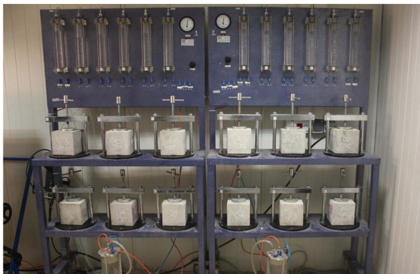
شکل ۶- دستگاه آزمایش نفوذ آب با ظرفیت ۱۲ آزمون
