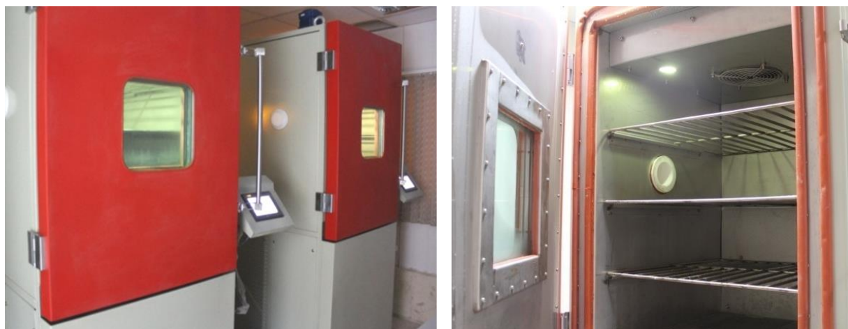
شکل ۴- دستگاه‌های شبیه ساز محیطی هوشمند موجود در آزمایشگاه بتن پروژه بزرگراه طبقاتی شهید صدر
