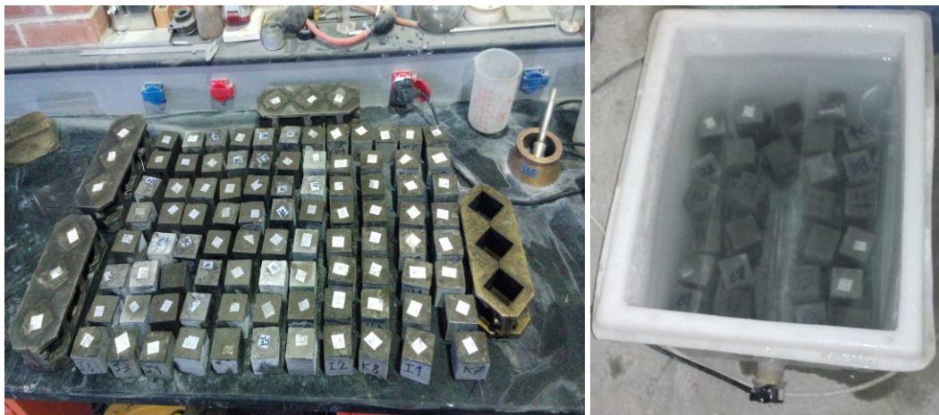
شکل ۲: نمونه های ساخته شده از RPC برای آزمایش مقاومت فشاری
