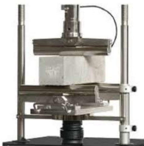
شکل ۱ روش انجام آزمون تعیین مقاومت خمشی تک نقطه ای
