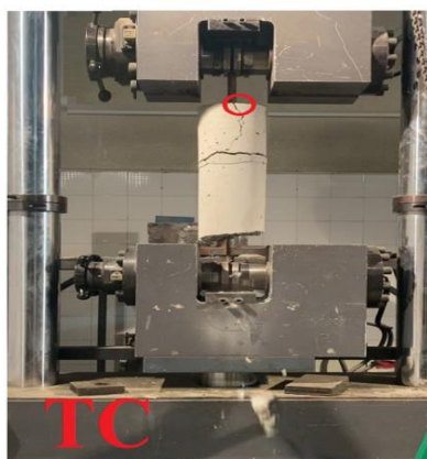
شکل ۵: ناحیه شکست نمونه‌های (NS, TC, RFWTC) تحت بارگذاری چرخه‌ای (میلگرد ۱۶ و ۲۰ میلیمتر)
