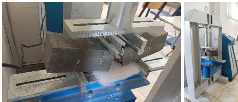
شکل ۶- آزمایش تعیین مدول گسیختگی بتن
