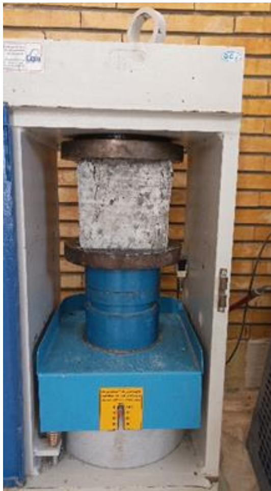
شکل ۳- آزمایش مقاومت فشاری بتن
