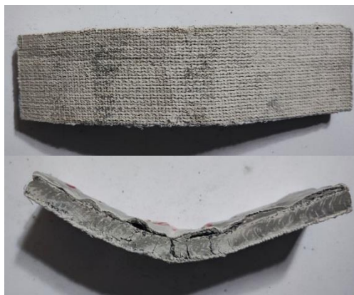
شکل ۴- بتن پارچه ای فاقد تقویت پس از بارگذاری خمشی
