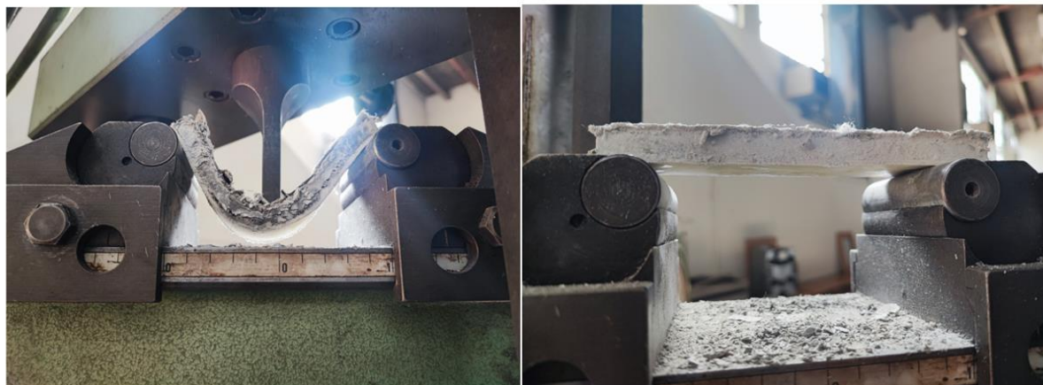
شکل ۷- روند توسعه ترک ونحوه گسیختگی ناشی از آزمون خمش در بتن پارچه‌ای تقویت شده با ۳ لایه AFRP
