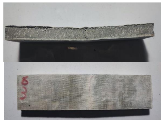
شکل ۶- توسعه ترک و نحوه گسیختگی ناشی از آزمون خمش در بتن پارچه‌ای تقویت‌شده با الیاف شیشه GFRP
