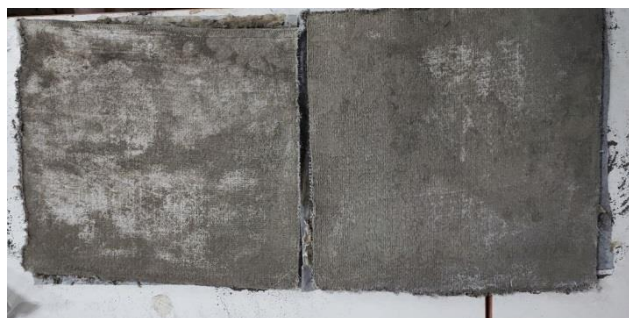
شکل ۲- پنل ساخته شده بتن پارچه‌ای پیش از اسپری نمودن آب رسانی و عمل آوری
