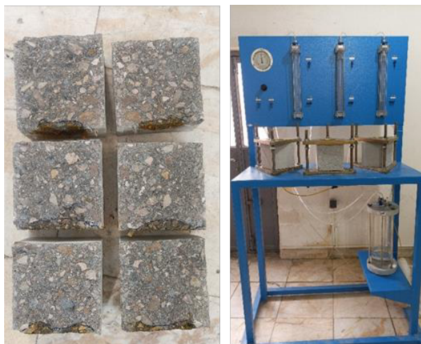
شکل ۹- آزمون‌ها در دستگاه نفوذپذیری و میزان عمق نفوذ آب در
