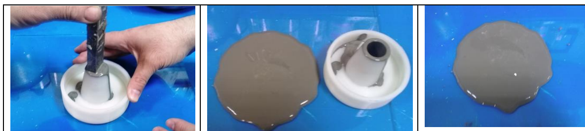
شکل ۳-انجام آزمایش مینی اسلامپ بر روی نمونه‌های مختلف
