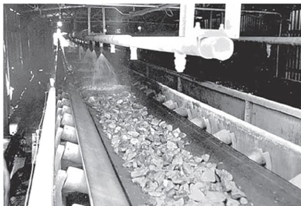
شکل ۵-۷-ب- سرمایش سنگدانه درشت از طریق پاشش آب سرد
