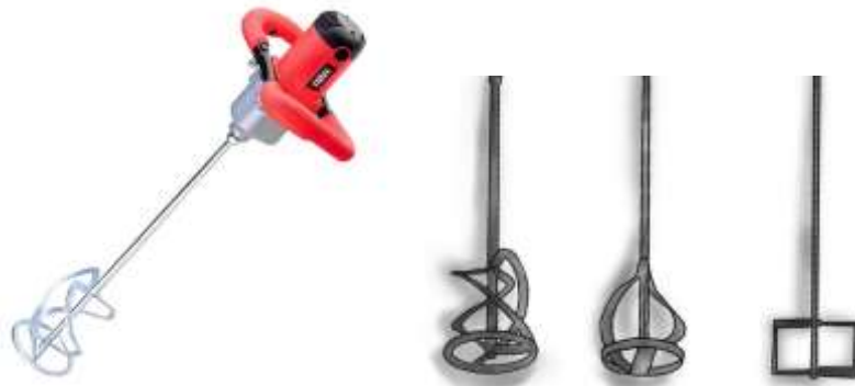
شکل ۱ - نوع مخلوط‌کن مجاز و نمونه‌ای از نوع پروانه‌های قابل استفاده
