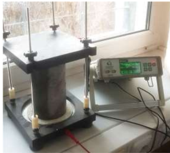
شکل ۲ آزمایش مقاومت الکتریکی
