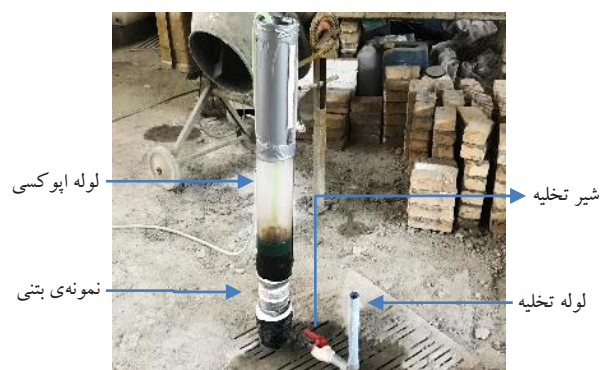
شکل ۳ دستگاه سنجش نفوذپذیری ساخته شده در تحقیق حاضر
