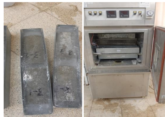
شکل ۳- دستگاه آزمایش اعمال چرخه‌های یخ‌زدن و آب‌شدن دانشگاه سمنان و آزمون‌های مورد آزمایش
