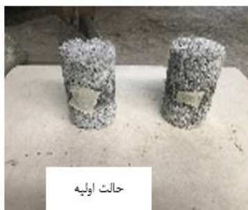
شکل ۵ تخریب نمونه‌های بتنی ناشی از افزایش سیکل چرخش در دستگاه لس آنجلس
