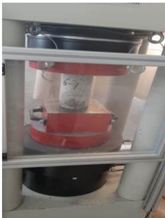
شکل ۲- آزمایش تعیین مقاومت فشاری آزمونه‌ها با دستگاه مربوطه
