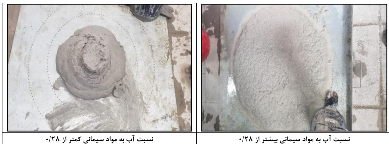
شکل ۳- نمونه ای از بتن های رد شده مرتبط با طرح مخلوط شماره ۲
