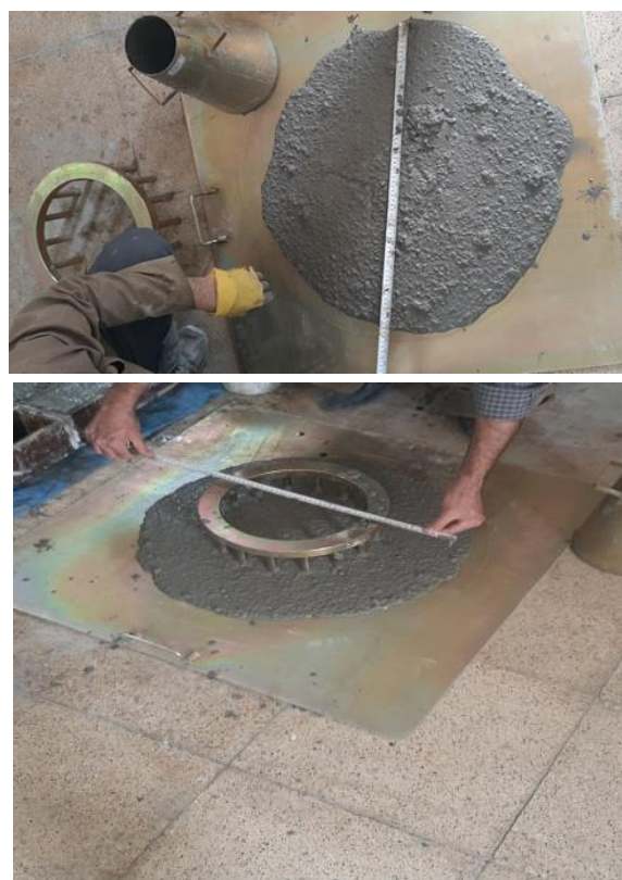
شکل ۴- اندازه‌گیری قطر پخش‌شدگی در آزمایش اسلامپ و حلقه J بتن خودتراکم
