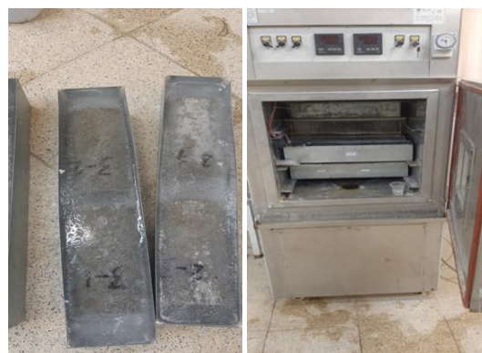
شکل ۳- دستگاه آزمایش اعمال چرخه‌های یخ‌زدن و آب‌شدن دانشگاه سمنان و آزمون‌های مورد آزمایش
