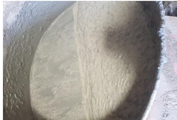
استفاده از مخلوط کن گرانشی با یک سرعت چرخش و جداسدگی بتن
