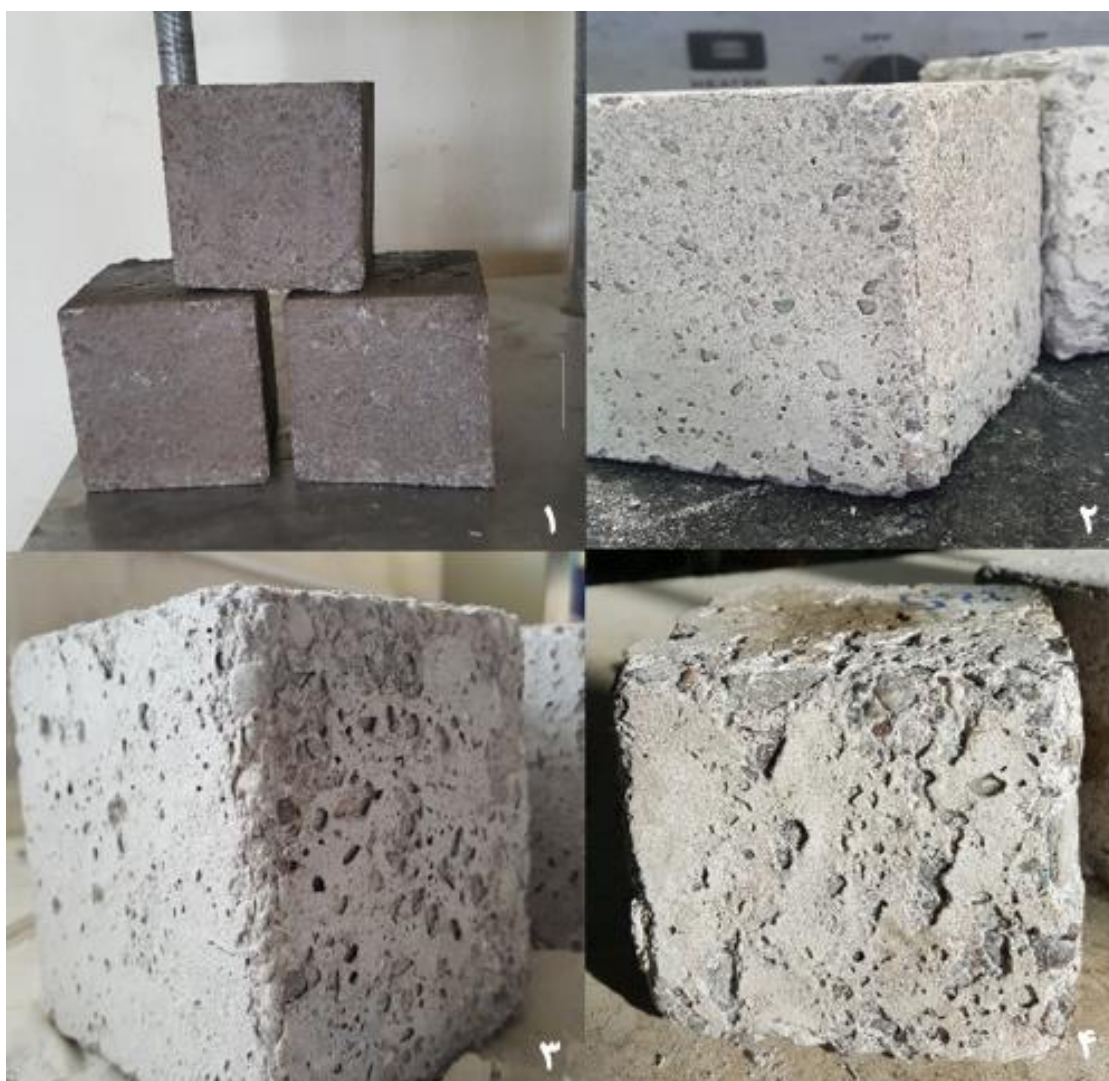
شکل ۴- شکلی ظاهری آزمون‌های ژئوپلیمری پس از خارج شدن از حوضچه اسیدی (۱- پس از ۲۸ روز عمل آوری در آب ۲- پس از ۲۸ روز قرار گیری در حوضچه اسید ۳- پس از ۵۶ روز قرار گیری در حوضچه اسید ۴- پس از ۹۰ روز قرار گیری در حوضچه اسید)
