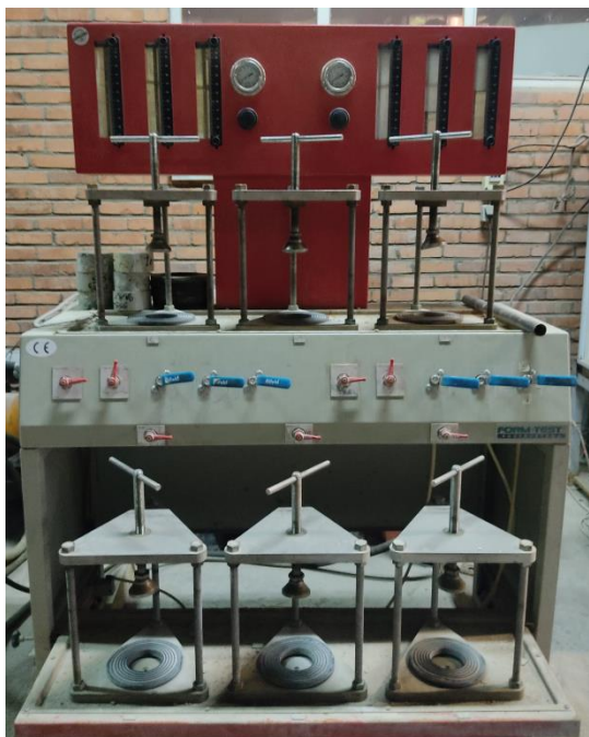
شکل ۳- دستگاه تعیین عمق نفوذ آب در بتن تحت فشار آب
