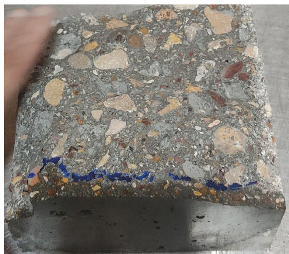
شکل ۵- علامت‌گذاری مسیر نفوذ (پیشروی) آب در بتن پس از اتمام آزمایش
