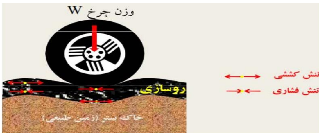
شکل شماره ۵: افت و خیز ناشی از تنش های فشاری و کششی در روسازی آسفالتی [۲]
