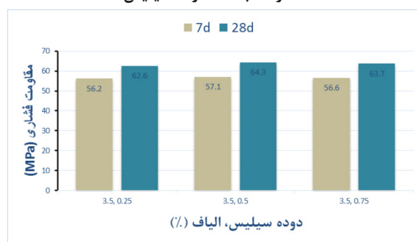
شکل ۱- مقاومت فشاری ۷ و ۲۸ روزه بتن‌های شامل دوده سیمان K2 ۳۶ درصد با فقط دوده سیلیس.
