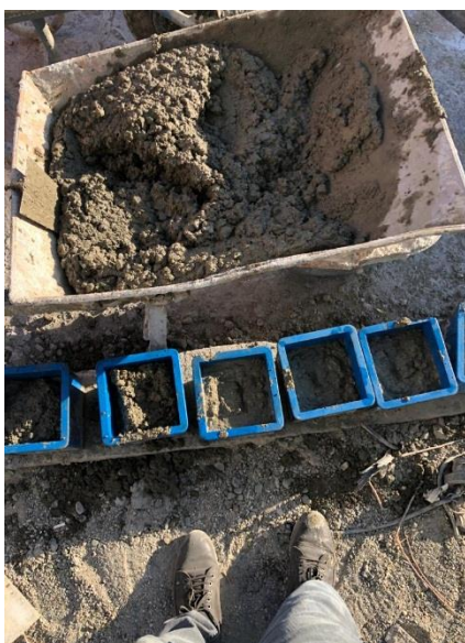
شکل ۱- نمونه‌گیری بتن تازه از کامیون حمل بتن
