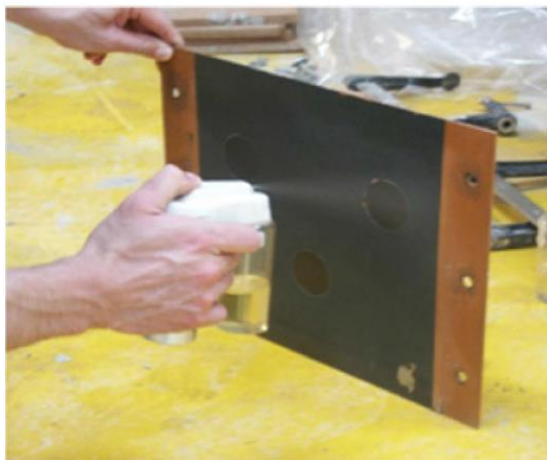
شکل ۱- اسپری کردن ماده رهاساز بر سطح قالب [۸]
