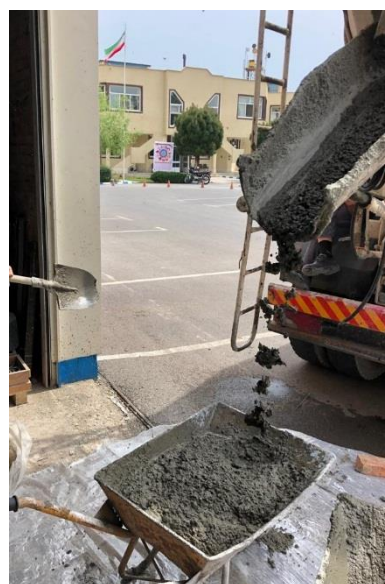
شکل ۱- نمونه‌گیری بتن تازه از کامیون حمل بتن
