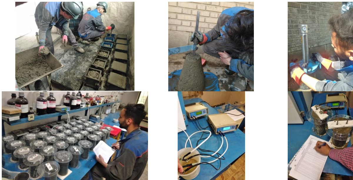
شکل ۴ تهیه مخلوطهای بتنی و آزمایش‌های مربوطه
