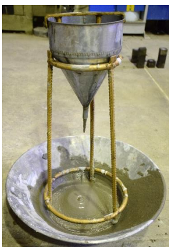
شکل ۶- مخروط سنجش روانی ساخته شده در آزمایشگاه
