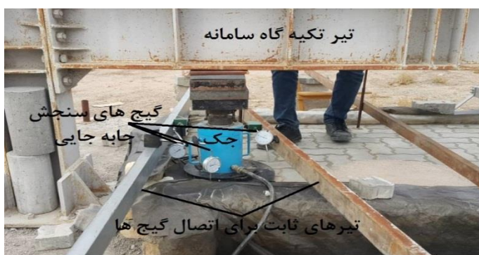
شکل ۴ نحوه انجام بارگذاری صفحه و محل فارگیری گنج های سنجش جا به جایی
