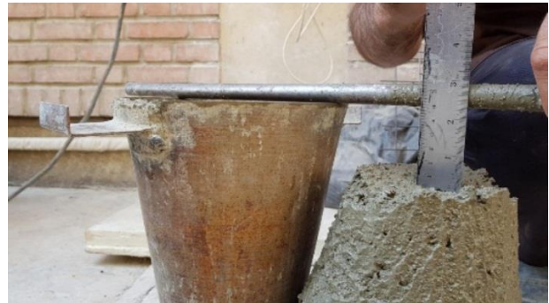
شکل ۴. ارزیابی کارایی مخلوط های بتن روسازی بتنی درزدار مطابق با استاندارد ASTM C143
