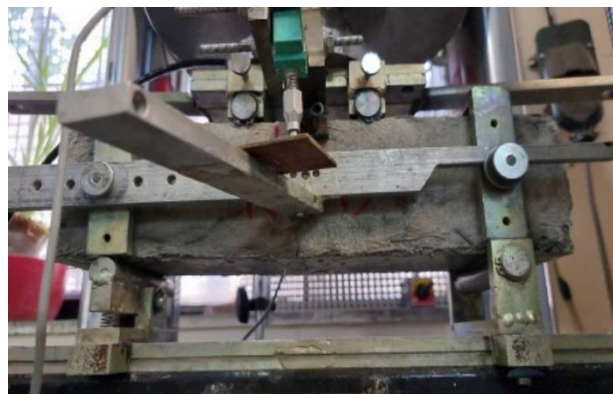
شکل ۵. ارزیابی مقاومت خمشی روسازی بتنی درزدار مطابق با استاندارد ASTM C78
