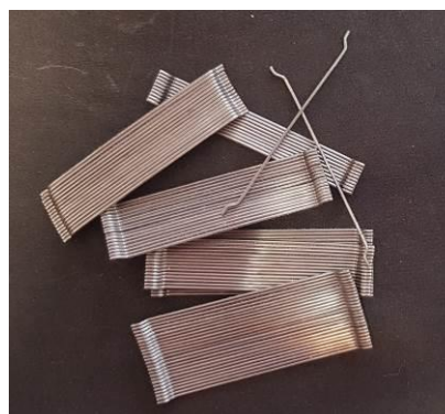
شکل ۲. الیاف فلزی با انتهای دو سر قلاب مورد استفاده در این تحقیق
