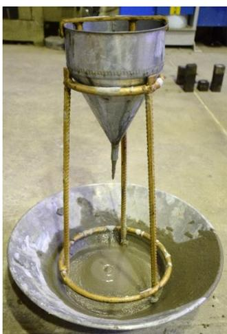
شکل ۶- مخروط سنجش روانی ساخته شده در آزمایشگاه
