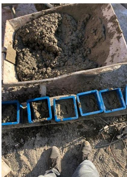
شکل ۱- نمونه‌گیری بتن تازه از کامیون حمل بتن
