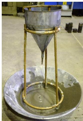
شکل ۶- مخروط سنجش روانی ساخته شده در آزمایشگاه
