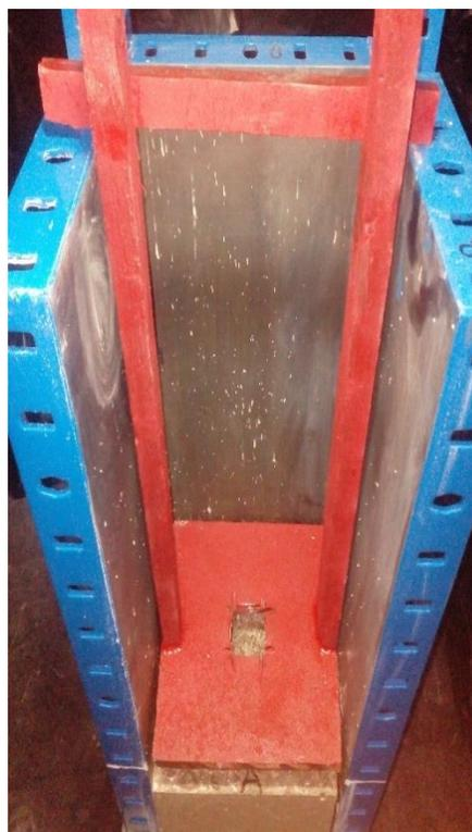
شکل ۵. شابلون قالب فولادی
