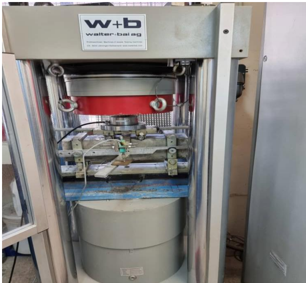
شکل ۶. دستگاه آزمایش ارزیابی عملکرد خمشی بتن مطابق با استاندارد ASTM C1609 به همراه نمونه ی تحت آزمایش
