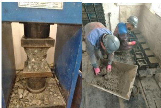
شکل ۹- تهیه مخلوط بتن آزمایشگاهی و تعیین مقاومت فشاری
