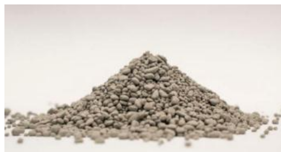
شکل ۱۳- سیمان گرانوله شده در کارخانه سیمان [21]
