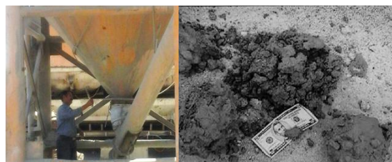
شکل ۲- نمانه‌ای از مشکلات کلوخه‌های سیمانی، گیر کردن در سیلو و تشکیل کلوخه بتنی
