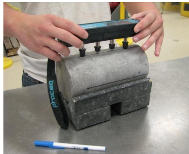
شکل ۱- نحوه‌ی اندازه‌گیری مقاومت الکتریکی سطحی آزمونه
