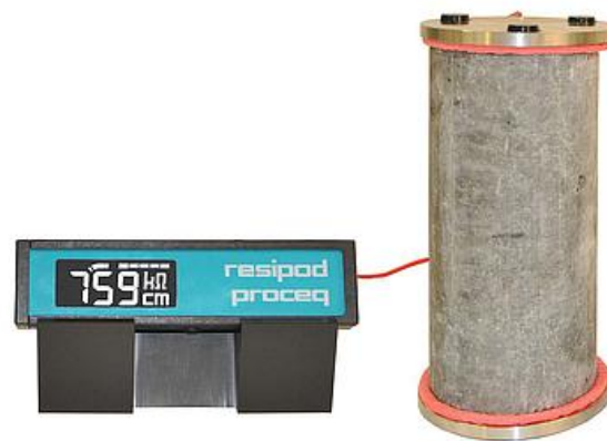
شکل ۲- نحوه‌ی اندازه‌گیری مقاومت الکتریکی حجمی آزمونه
