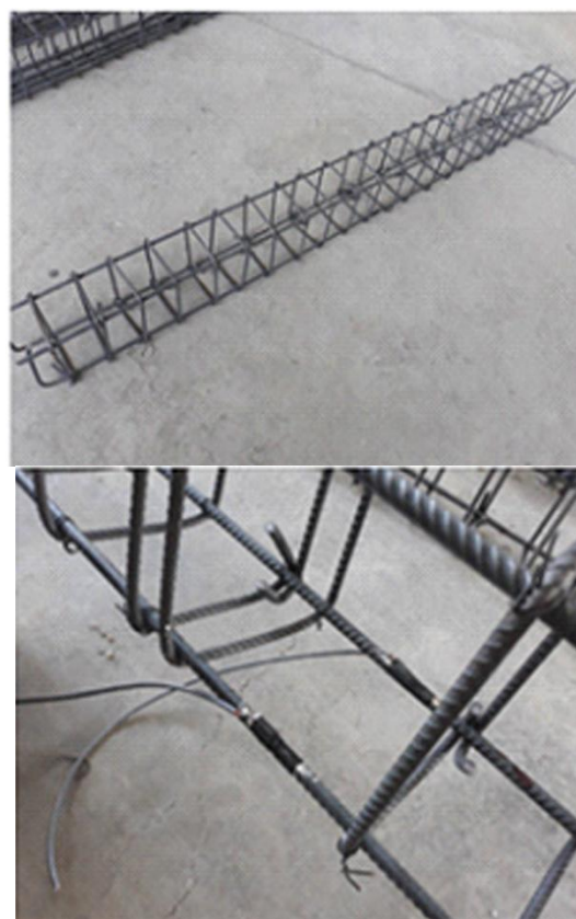
شکل ۴: محل قرار گیری کرنش سنج‌ها
