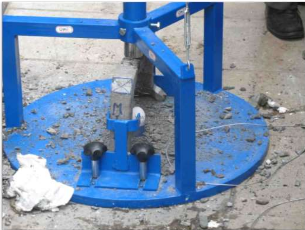
شکل (۳) - جزئیات جک و پیچ های تنظیم اولیه استقرار قاب در زیر جک که فقط یک بار تنظیم خواهد گردید.
