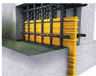
(شکل ۴-۱-۲ واتراستاپ PVC در محل درز انبساطی) (شکل ۴-۲ واتراستاپ PVC در محل درز اجرایی) (شکل ۴-۳ واتر استاپ مسی)
