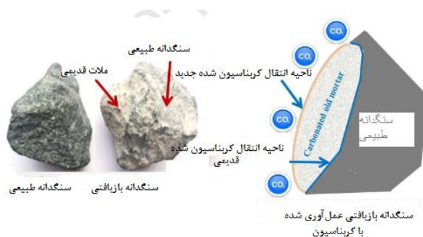
شکل (۲) - نمایش سنگدانه بازیافتی و سنگدانه بازیافتی عمل‌آوری شده با CO_2 [۱۳]
