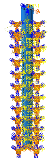
شکل ۳- مدل المان محدود تک شمع بتنی مدفون در خاک
