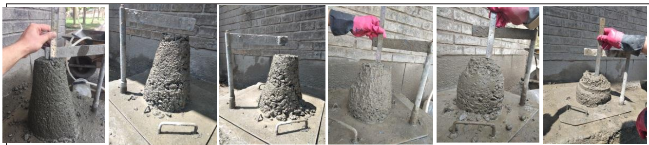
شکل ۸- اندازه گیری روند افت اسلامپ طی یک ساعت
