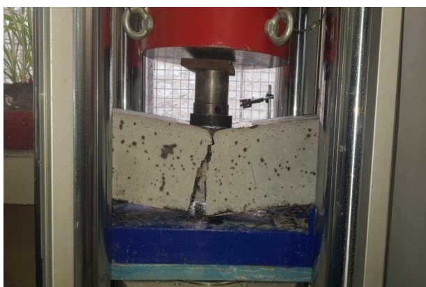
شکل ۷- تعیین عملکرد خمشی تیر های بتنی مطابق با استاندارد ASTM C1609
