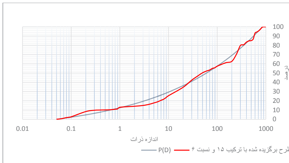
شکل ۲ منحنی دانه‌بندی معیار و طرح برگزیده شامل ترکیب ۱۵ و نسبت ۶
