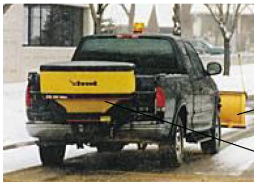
شکل ۳: دستگاه پخش کننده محلول ضد یخ نصب شده روی وانت مخصوص [۵]
