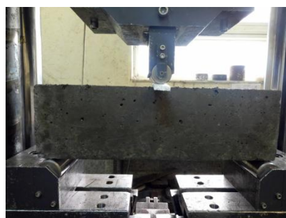
شکل ۱۰- آزمایش بار نقطه ای مرکزی
