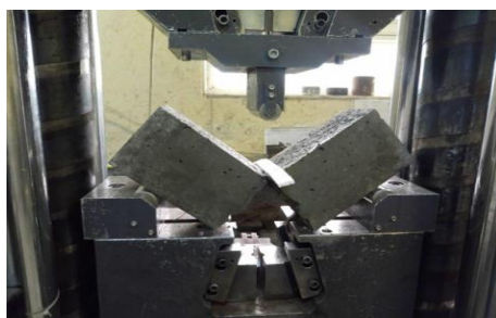
شکل ۱۲- نحوه گسیختگی آنی نمونه فاقد الیاف (PC)
