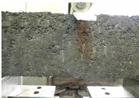
شکل ۱۴- نحوه ترک خوردگی نمونه حاوی الیاف ۱۲ میلی متر
