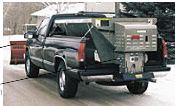
شکل ۳: دستگاه پخش کننده محلول ضد یخ نصب شده روی وانت مخصوص [۵]
