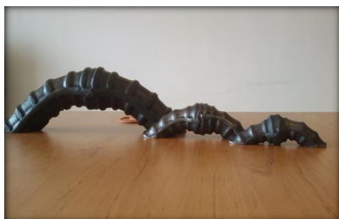
شکل (۴) - کنترل چشمی آزمایش خمشی
