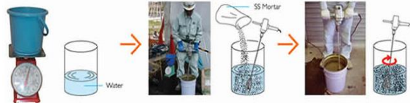
شکل (۲۳) - ترکیب و تهیه گروت در وصله تزریقی
